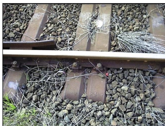
Fig. 14 Ĝemeligita ŝpalo de la „Baden”-tipa ferŝpalo
