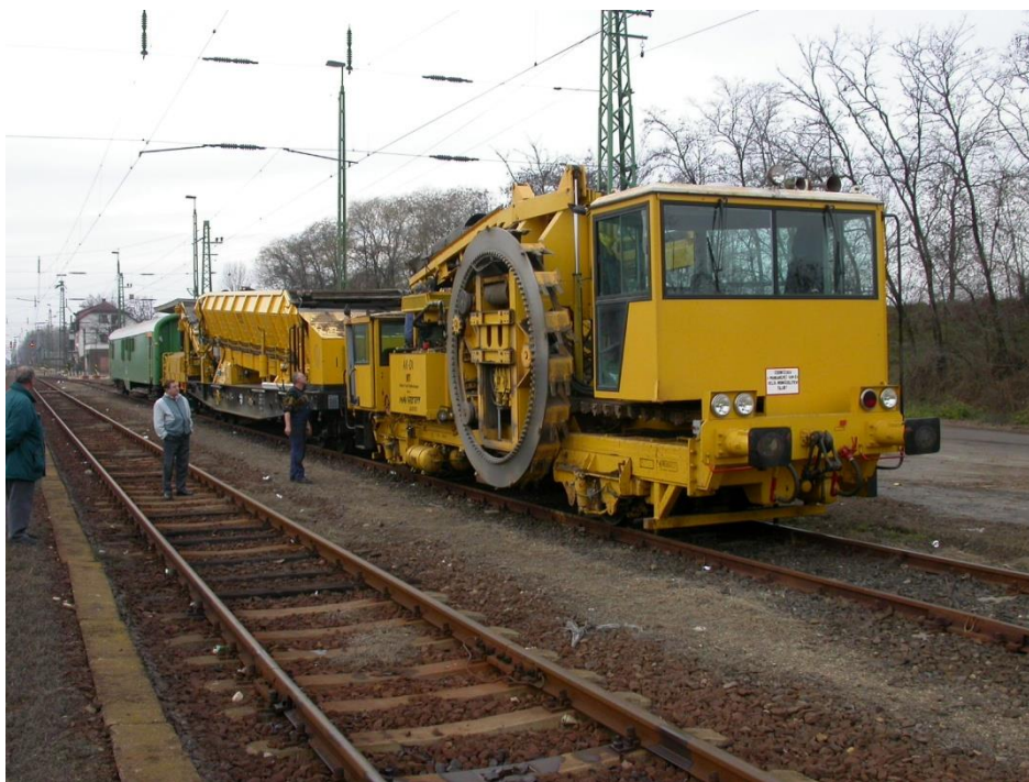
Fig. 16 Balastforiga maŝino por ĉesigi la lokajn trakdeformiĝojn
