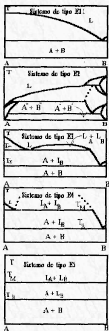
Fig. 1. Skema desegnaĵo de diagramoj de ekvilibro de sistemoj, havantaj tendencon al distavoliĝo en likva stato. Ekzemploj de duoblaj sistemoj de nemiksigaĵantaj komponantoj.
